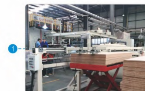
自动升降台+推板机构 Lifter + Pusher
